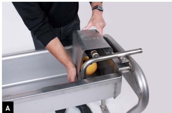
Schwimmerabdeckung schnell und ohne Werkzeug abnehmbar. Sicherungssplint lösen und Bolzen durch die Flacheisenbohrung drücken.
