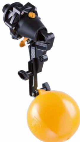
Hochleistungs-Schwimmerventil TOPAZ mit Wasserdurchfluss von 80 l/min bei 4 bar Leitungsdruck. Die Raster-Schiene lässt den Wasserstand im Trog variabel ändern. Stopp-Funktion und Frostschutzsicherung sind zusätzliche Optionen des TOPAZ. Der Bajonettschluss lässt das komplette Ventil einfach und schnell demontieren und reinigen und mit einem Arbeitsbereich von 0,3 – 7 bar ist er für nahezu alle Leitungsnetzdrücke einsetzbar.
